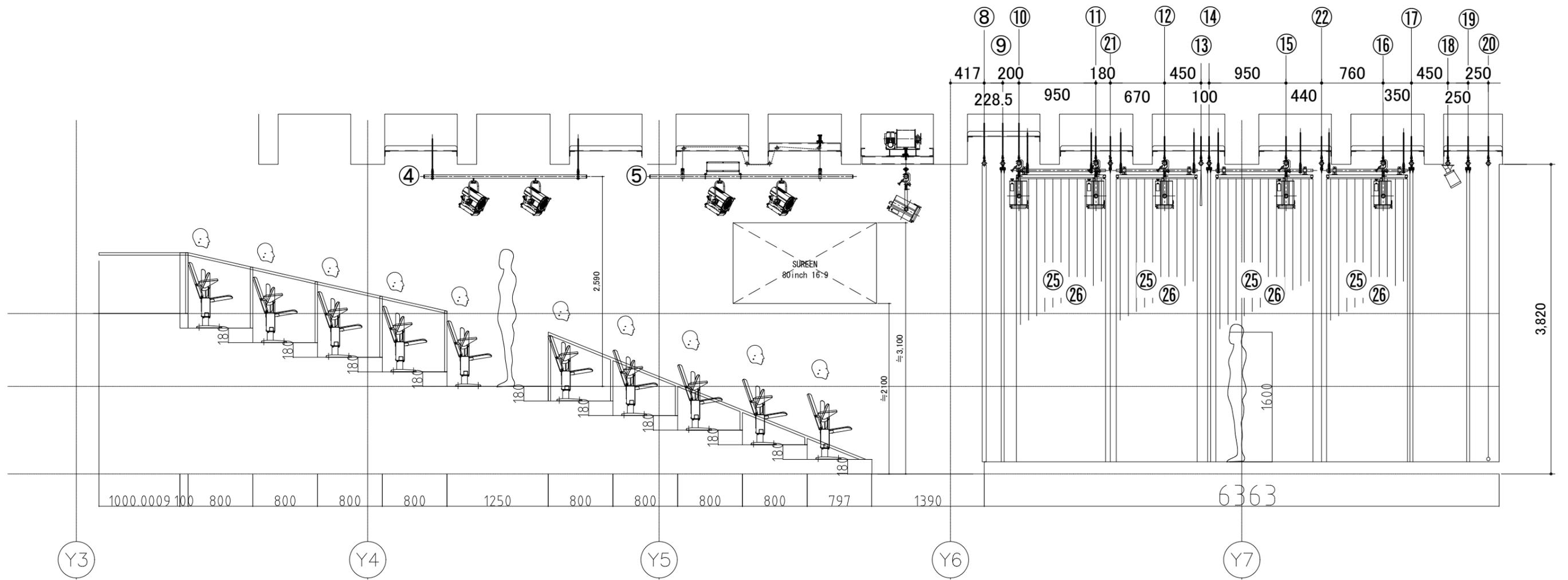
吊物壁面断面図 S=1/25
